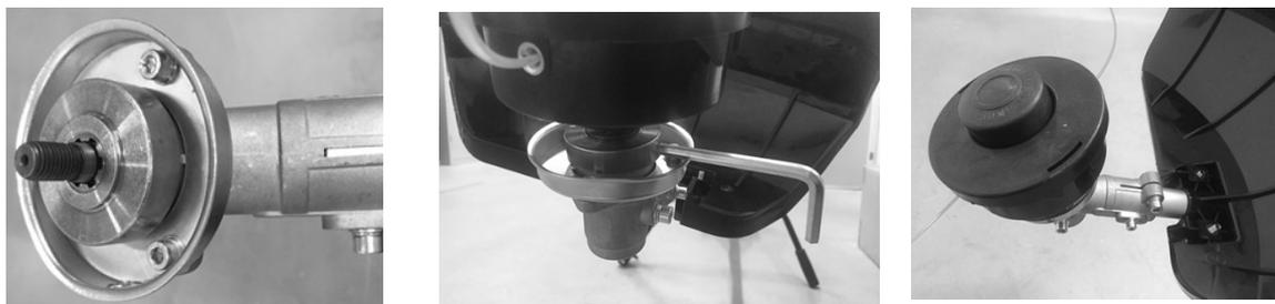
Para retirar el cabezal de corte, coloque una herramienta de bloqueo en el orificio del eje. Luego desenrosque el cabezal de corte. Esto deberá hacerse con la herramienta apagada y enfriada.
